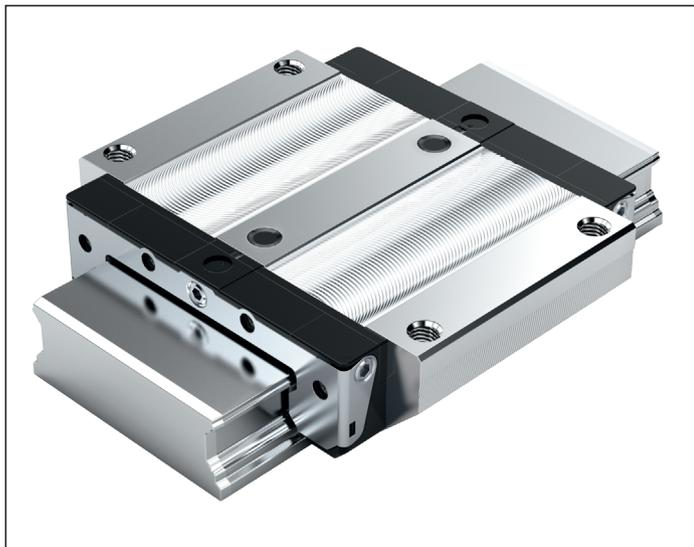
**Pattino a sfere in acciaio****R1671 ... 2.****Fattori dinamici**Velocità:  $v_{\max} = 5 \text{ m/s}$ Accelerazione:  $a_{\max} = 500 \text{ m/s}^2$ (Se  $F_{\text{comb}} > 2,8 \cdot F_{\text{pr}}$ :  $a_{\max} = 50 \text{ m/s}^2$ )**Nota per la lubrificazione:**
