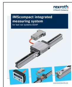
用于滚珠和滚子导轨导向系统的集成测量系统 IMS
